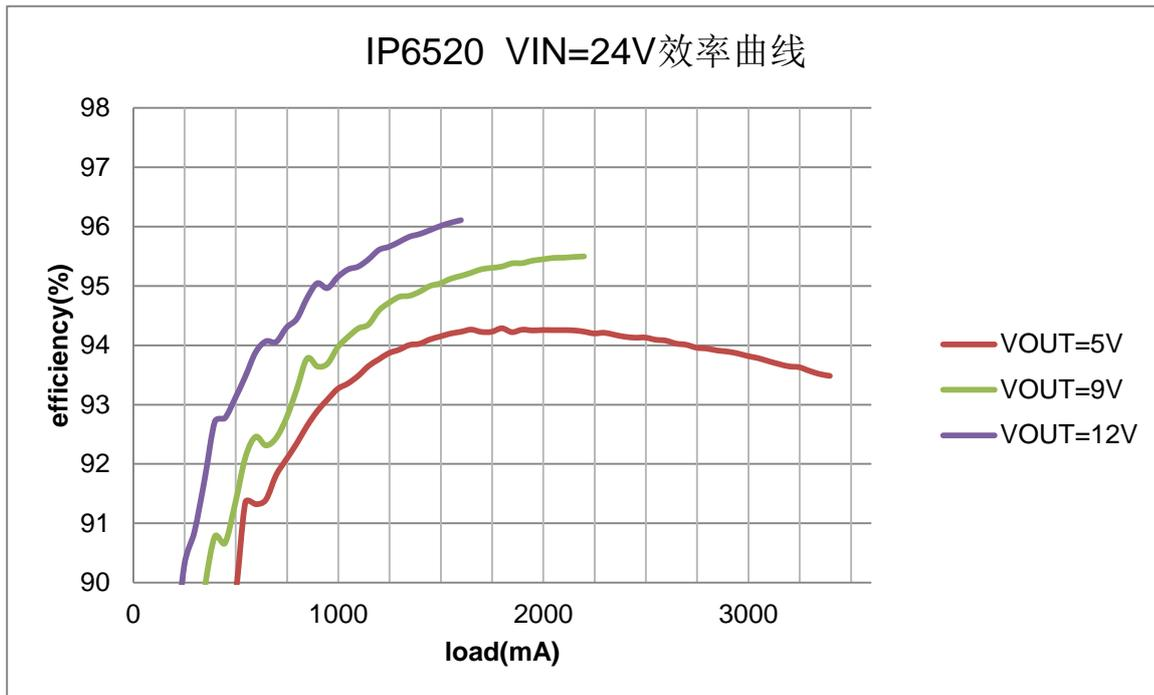
图 4 IP6520 VIN=24V 时的效率曲线
