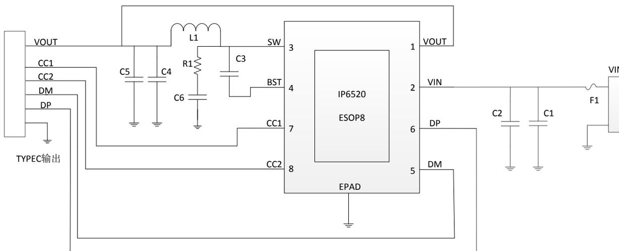
图 1 IP6520 简化应用原理图
