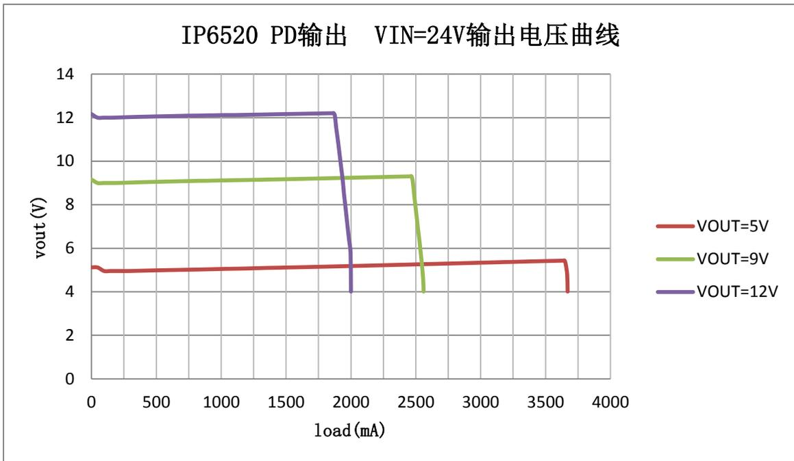
图 5 IP6520 VIN=24V PD 输出时 Vout-lout 曲线
