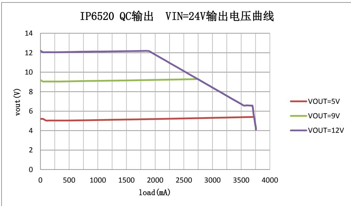
图 6 IP6520 VIN=24V QC 输出时 Vout-lout 曲线
