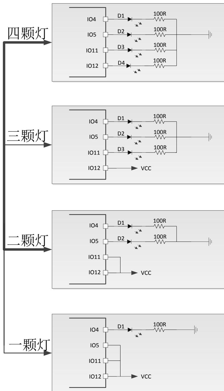
图 8 LED 显示配置电路图
