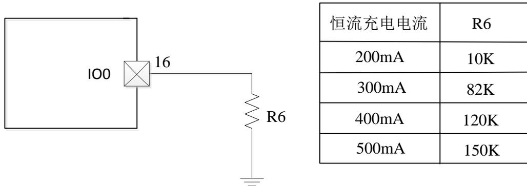
图 6 恒流充电电流设置电路
