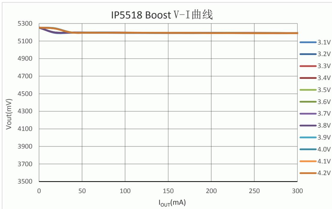
图 5 IP5518 升压 V-I 曲线图
