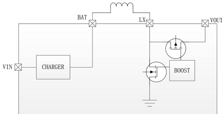
图 7 IP5518 路径管理示意图
