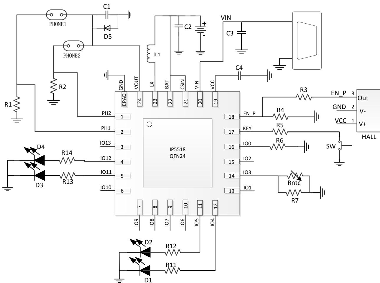
图 1 IP5518 简化应用原理图
