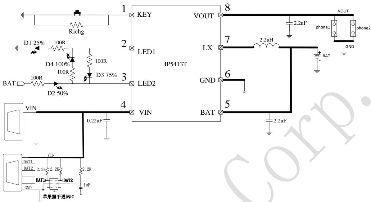
图 11 4LED 电量显示典型应用原理图
