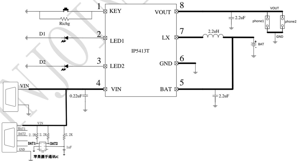
图 10 2LED 电量显示典型应用原理图
