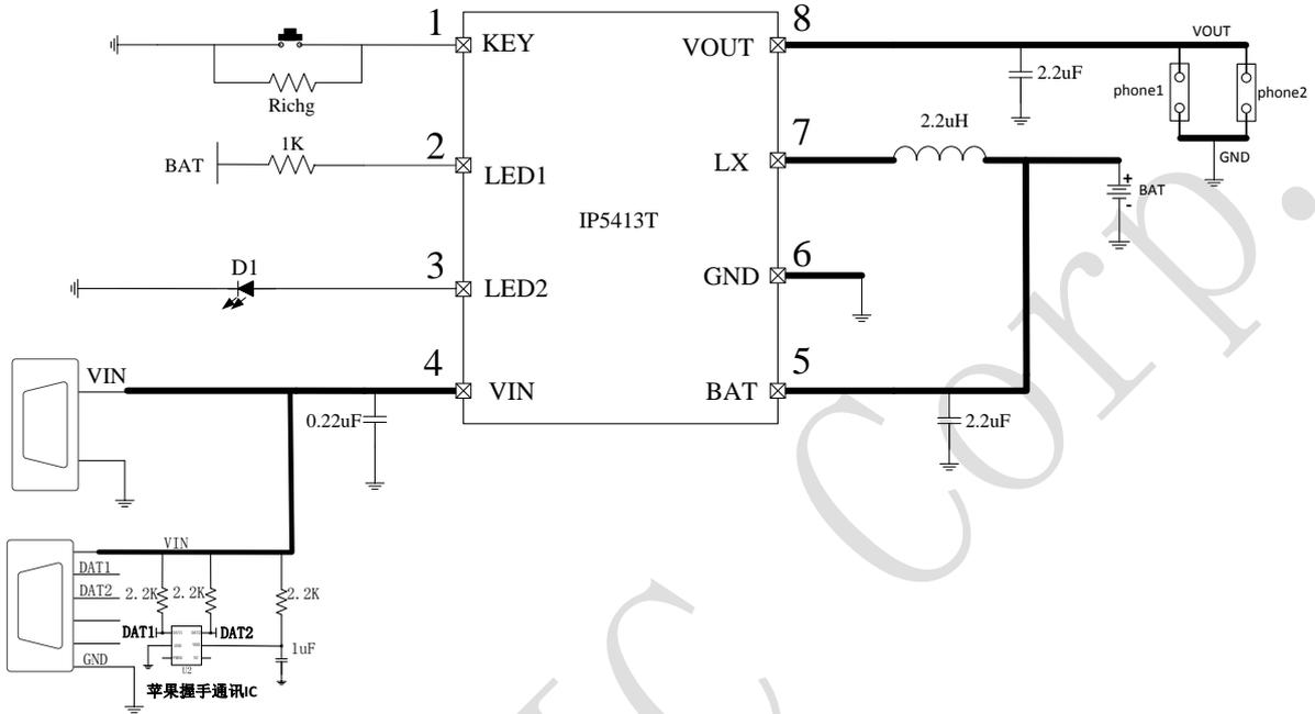
图 9 1LED 电量显示典型应用原理图
