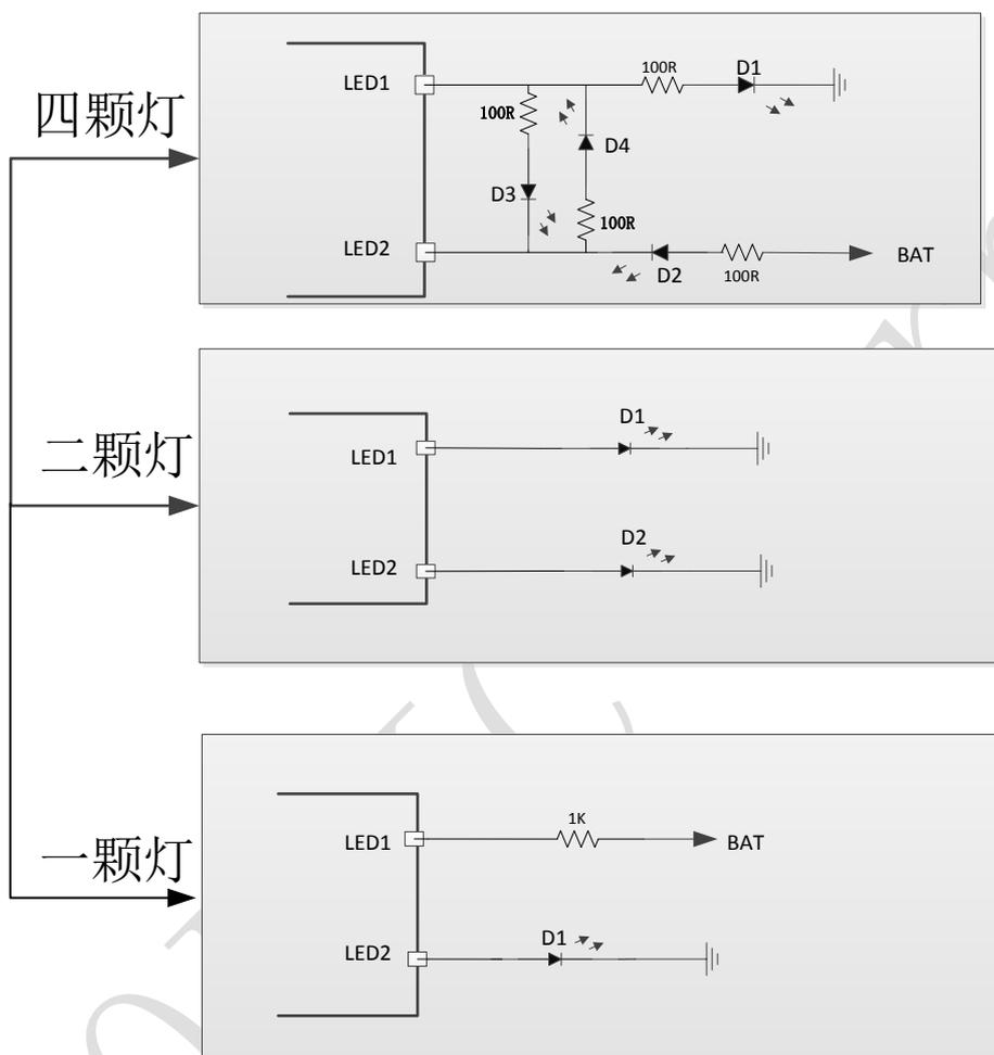
图 7 LED 显示配置电路图
