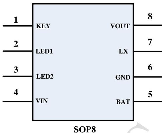
图 2 IP5413T 引脚图
