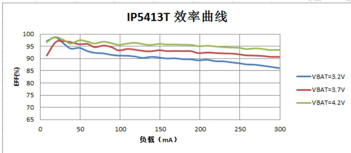
图 4 IP5413T 升压效率图
