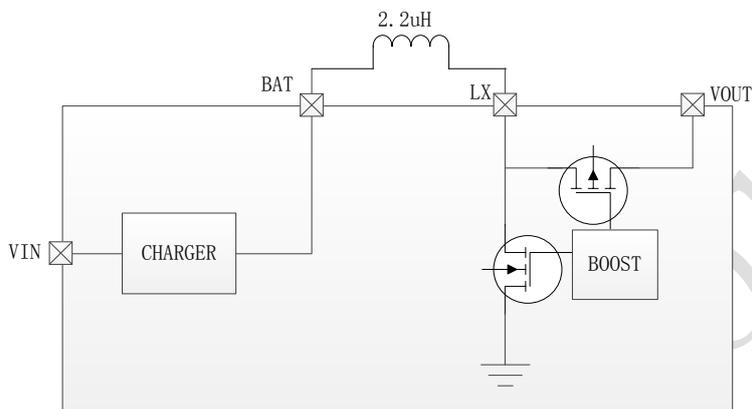
图 6 IP5413T 路径管理示意图
