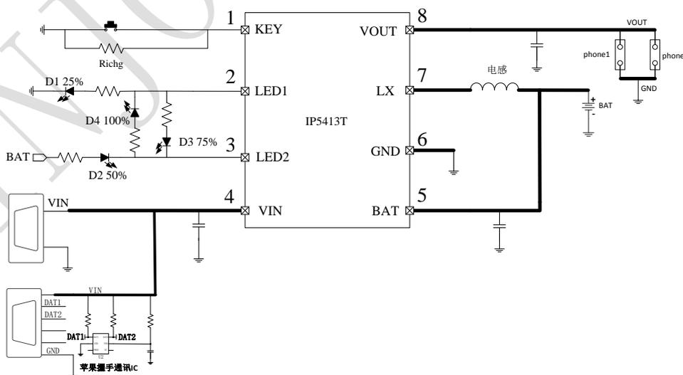
图 1 IP5413T 简化应用原理图
